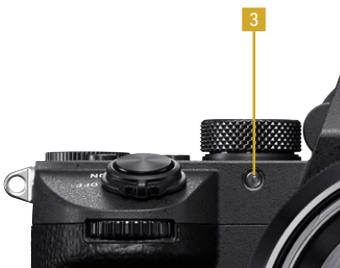
Abbildung 3.2: Das AF-Hilfslicht kann den Autofokus bei schlechten Lichtverhältnissen unterstützen.
